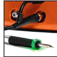
当形成良好的焊点时, 装有 LED 灯环的手柄向操作员发出信号。
