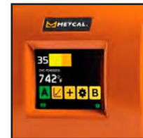
Die Artikel-Nr. der Lötspitze und deren Temperatur wird auf dem Display angezeigt
