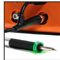
Lötgriffel zeigt dem Anwender über eine LED „gute“ Lötverbindungen an
